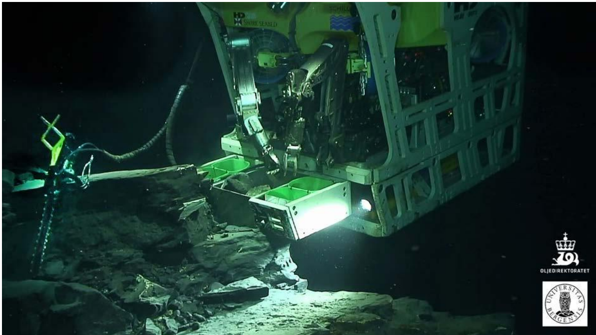
Bilde 7. Prøvetaking utført av Oljedirektoratet i 2013 på Vøringsutstikkeren, 3 000 meters vanddyp. Til venstre fjernstyrt motorsag for å sage løs steinprøver. (Foto: Universitetet i Bergen)
