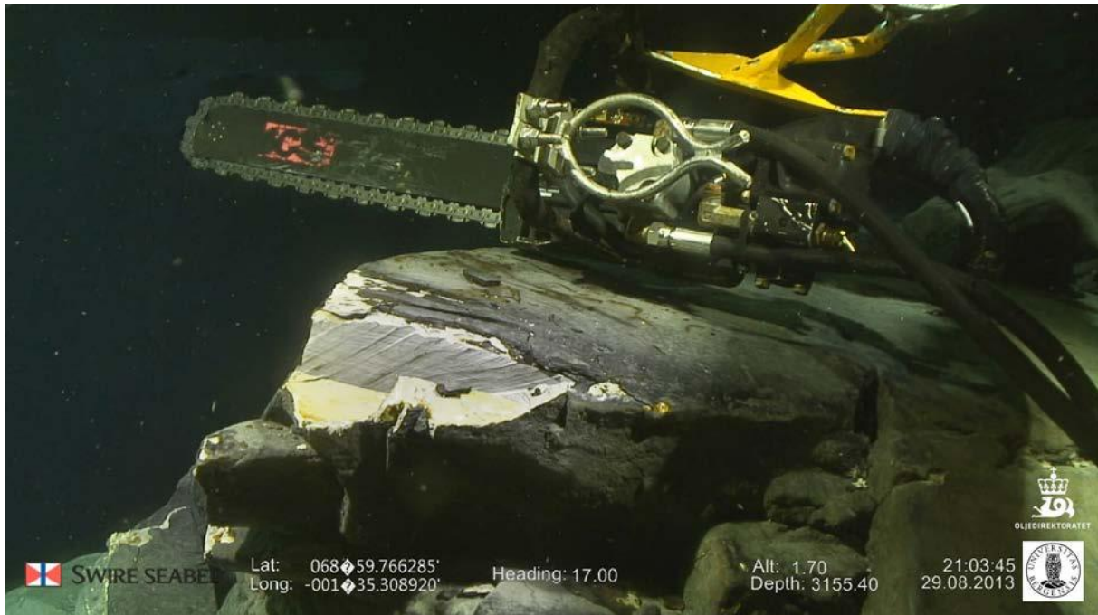
Bilde 5. Saget snitt i vulkansk bergart med en tynn manganskorpe, 3 155 meters vanddyp. Utført av Oljedirektoratet i 2013 på Vøringsutstikkeren. (Foto: Universitetet i Bergen)
