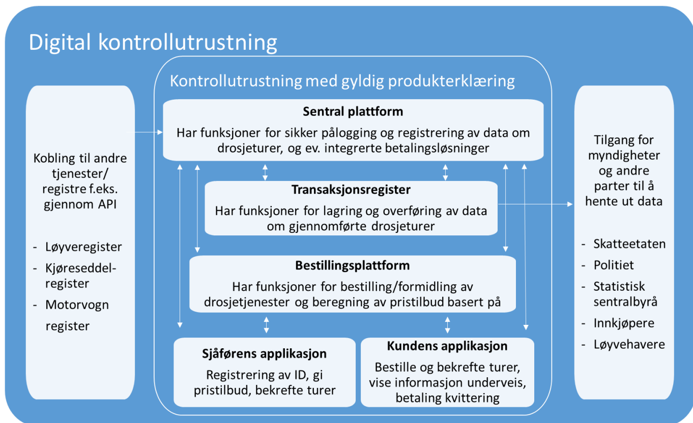
Figur 1: Skisse av potensiell løsning for kontrollutrustning
