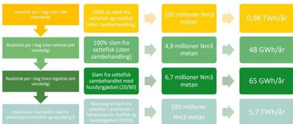
Figur 2: Teoretisk gassutbytte fra fiskeslam fra ulike scenarier. 60,5 Nm 3 /tonn fiskeslam (15% TS) og 16,5 Nm 3 /tonn blanding av 20% fiskeslam og 80% husdyrgjødsel. Spesifikt energiinnhold til metan: 9,8 kWh/Nm 3 metan (Kilde: Joshua Cabell)
